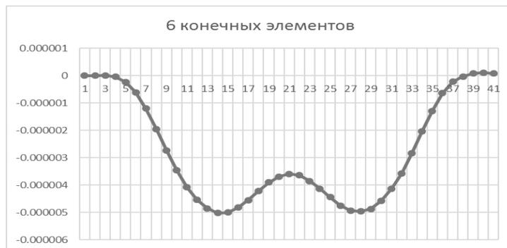
Рис. 3 Результат при количестве шагов интегрирования 40, с использованием алгоритма понижения размерности. Расчетная схема была разбита на 6 конечных элементов.
